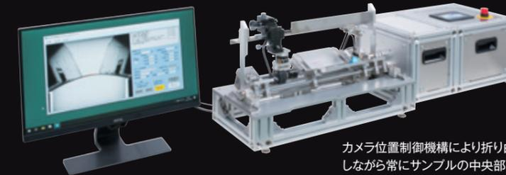
カメラ位置制御機構により折り曲げに伴うサンプルの上下動を相殺しながら常にサンプルの中央部画像の撮影を可能にしています。
