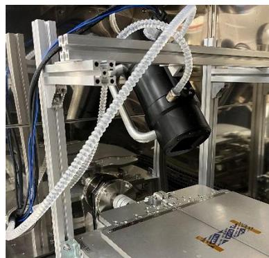
恒温恒湿槽内で環境試験中のサンプルの状態を常時撮影できるカメラシステムです。カメラと照明を筐体（エンクロージャー）に内蔵し、エア循環方式で内部温度を制御することで、過酷な環境下（-40℃～85℃/85%R.h.）での撮影が可能です。お持ちの恒温恒湿槽を改造することなく、そのままご使用いただくことが可能です\*。専用台座に取り付けたエンクロージャーは、恒温恒湿槽外から位置調整を行うことができ、試験中のサンプルの様々な位置の撮像が可能です。また、同時に複数のエンクロージャーを設置し、使用することも可能です。
