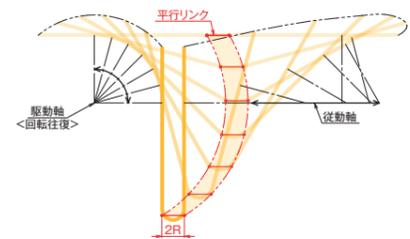
2枚のプレートにサンプルを保持し、片方のプレートを回転往復駆動軸により動作させます。2枚のプレートは平行リンクによって、互いに同じ角度を保ちながら開閉します。
